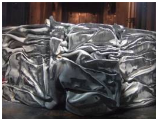
模擬廃棄物①の圧縮状況
